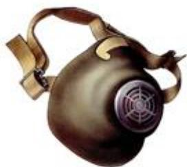
Наружная оболочка полумаски изготовлена из пенополиуретана (пористого синтетического материала), а внутренняя из тонкой воздухонепроницаемой пленки, в которую вмонтированы клапаны вдоха. Между наружной и внутренней оболочками расположен фильтр из полимерных волокон.
